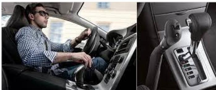
Existem três modelos Carospeed Classic: o modelo Standard, que possui apenas as funções básicas de travão e acelerador. O modelo Indicator, que incorpora os indicadores de direção e, por fim, o modelo E que é equipado com as funções elétricas dos indicadores de direção, limpa para-brisa, lava-vidros, buzina, médios e máximos, bem como a função de ajuste do Cruise Control, ao nível do botão.
