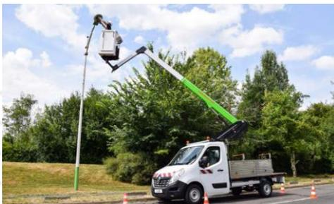
Com uma altura de trabalho de 11,80m e um deslocamento de 6,80m, esta plataforma de trabalho aérea sobre chassis de 3,5t é uma solução muito eficiente para trabalhos de manutenção de iluminação pública, manutenção de espaços verdes, instalação de câmaras de video vigilância.
